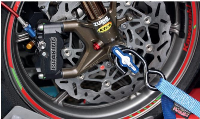
Das Prinzip ähnelt in der Handhabung der Befestigung von Achsprotektoren. Nur, dass Axfix innerhalb von rund 30 Sekunden fest sitzt und kann sofort den Spanngurt und Haken zum Befestigen aufnehmen. Viel mehr muss zur eigentlichen Funktion nicht gesagt werden.
