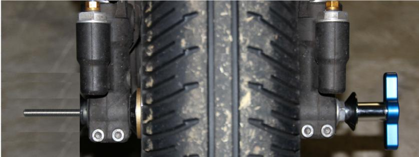
2. Kegel mit Gewinde von der anderen Seite aufschrauben bis er an der Hohlachse Rundum leicht anliegt.
