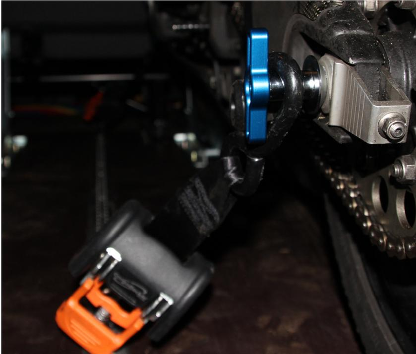
2. Gurt links und rechts im Wechsel spannen und darauf achten das dass Fahrzeug gerade steht. Im Normalfall reichen hier ein bis zwei clicks bei einem Handelsüblichen Ratschengurt.
